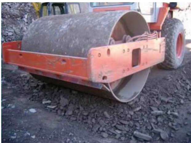
Figura 6. Teste de campo para determinação do fator de redução por danos mecânicos.
