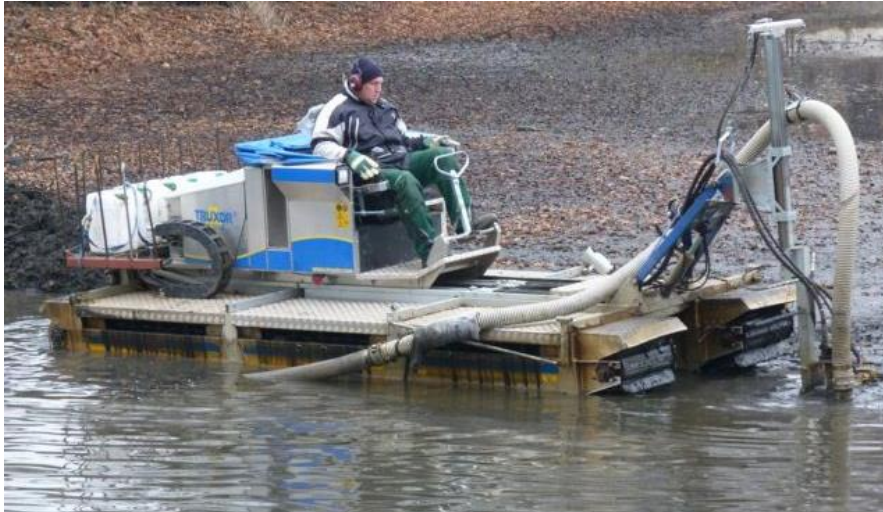
Abb. 3 Förderung des angelagerten Sedimentes mit Hilfe eines Saugbaggers
