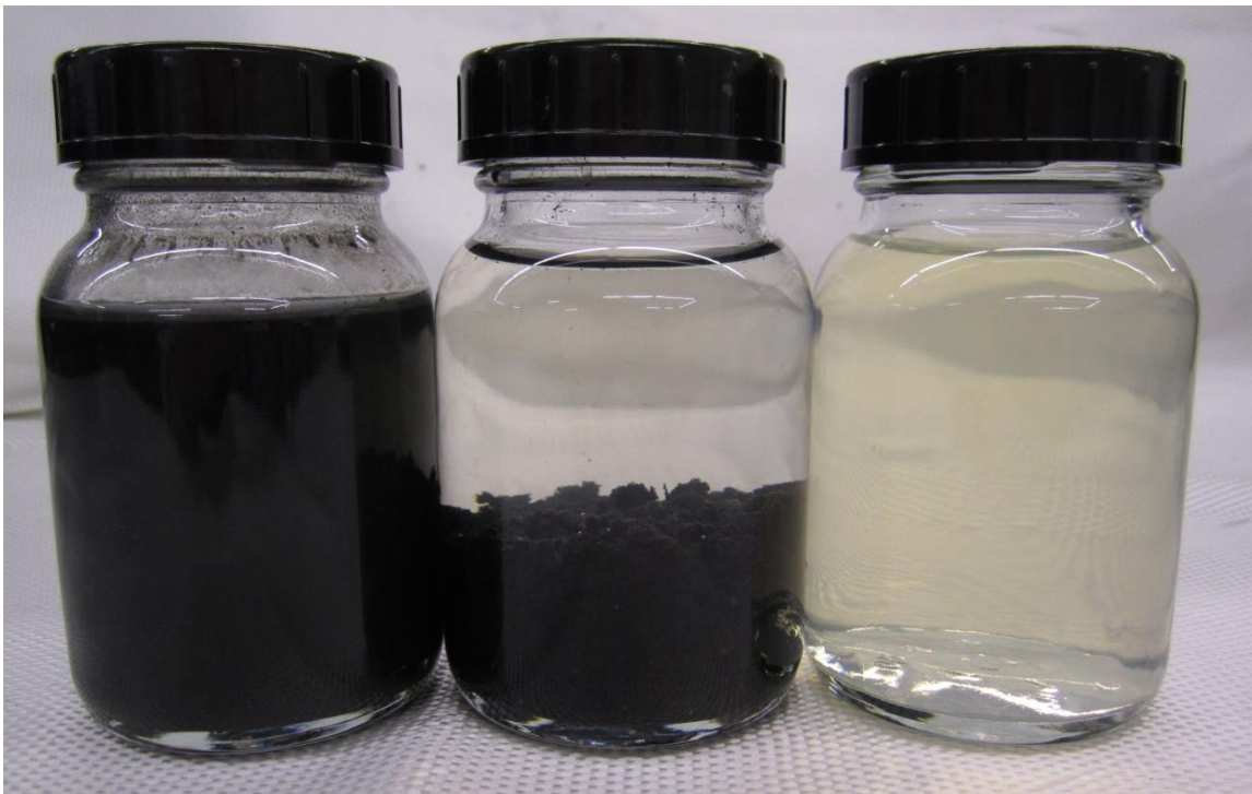
Abb. 6 Einfluss der Zugabe von Flockungshilfsmitteln und nachfolgender Filtration mit einem geosynthetischen Schlauchgewebe
