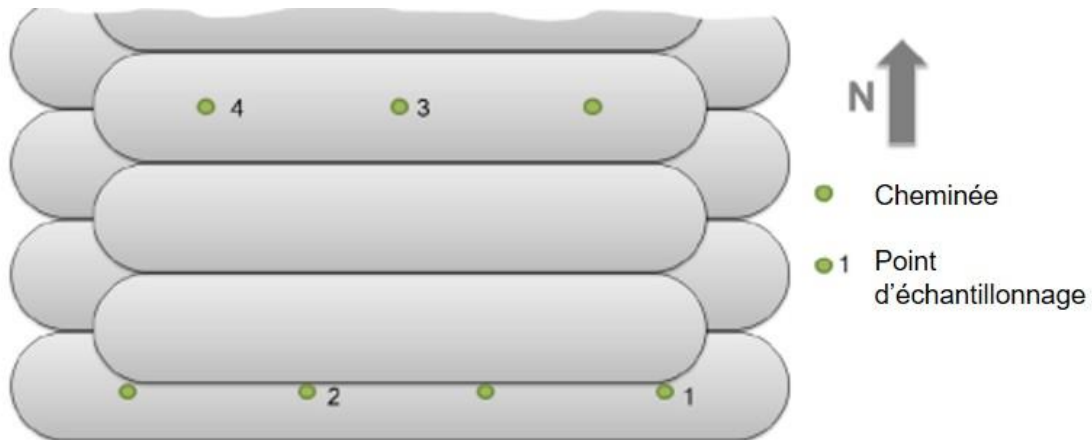
Figure 7 : Localisation des cheminées et des points d'échantillonnage
