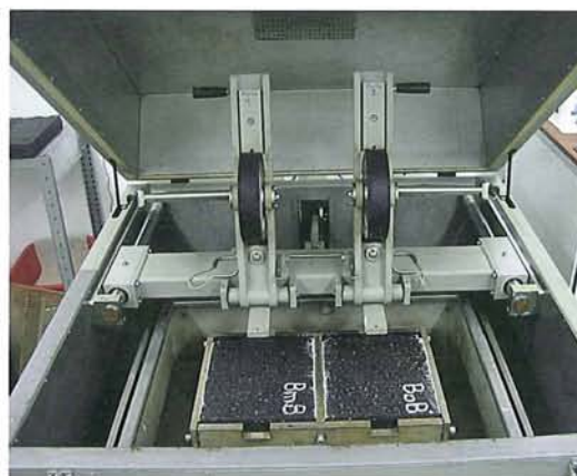
Bild 1: Modifizierter Spurbildungsversuch mit Probekörpern
