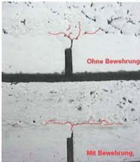
Bild 4: Probe mit Betonunterlage nach 40.000 Überrollungen
