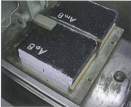
Bild 2: Spurbildungsversuch Rahmen ohne Seitenteile
