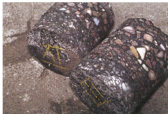
Bild 2. Bohrkern mit Gittern
